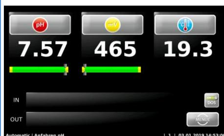
Befindet sich einer der beiden Messwerte pH oder mV nicht im Regelbereich, so startet die Startroutine. Bitte beachten Sie die pH- Vorrangdosierung.
