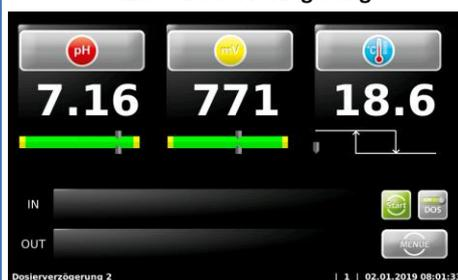
Wird das Gerät neu gestartet, läuft die Dosierverzögerung ab während der keine Dosierung erfolgt.
