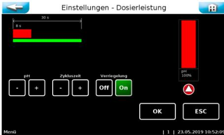
Die untere Abbildung zeigt das Menü Dosierleistung, wenn für die Desinfektionsdosierung die Regelart 2-Punkt bzw. Zeitsteuerung gewählt wurde.
