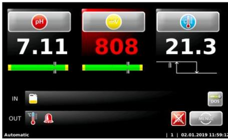
Eingetretene Alarme und Störungen werden durch das Symbol in der OUT-Liste signalisiert, das Alarmrelais ist aktiviert.
